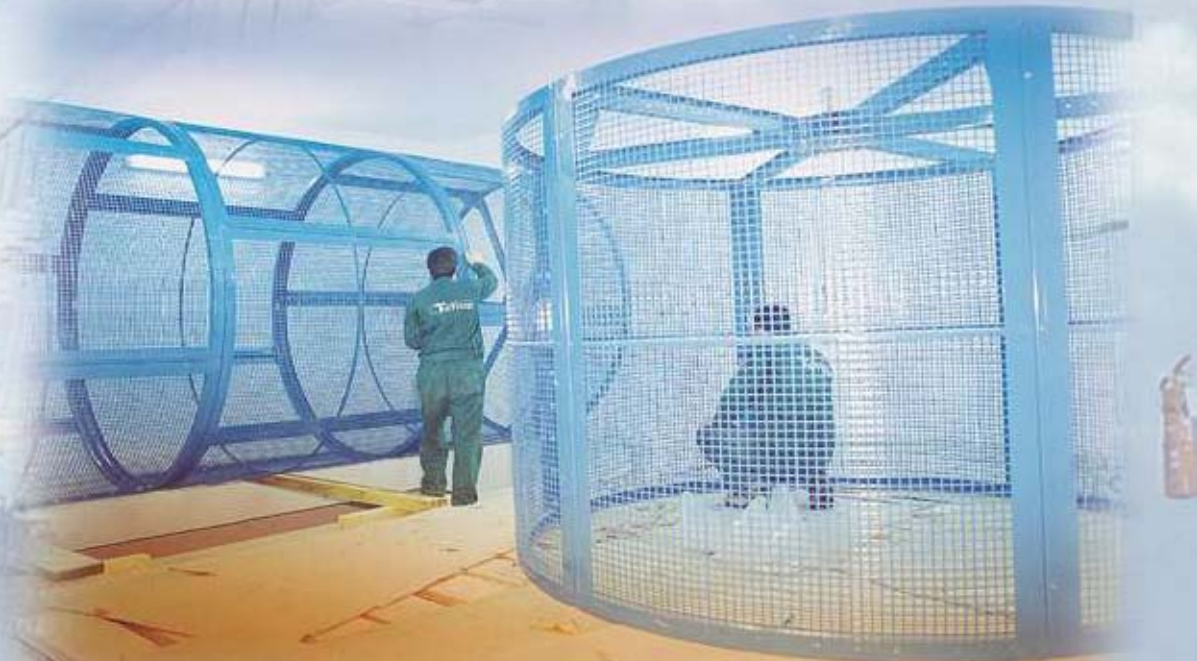
Döner Filtre montajı Rotary filter installation
